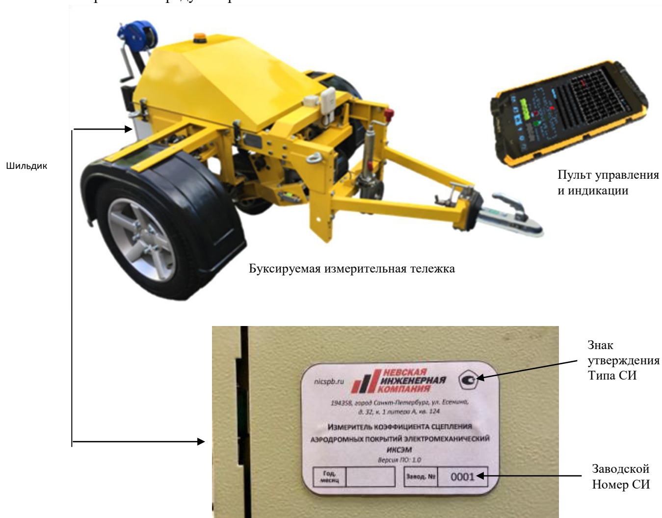
Рисунок 1 – Общий вид измерителя электромеханического коэффициента сцепления аэродромных покрытий ИКСЭМ
