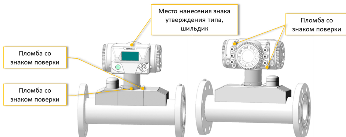
Рисунок 4 – Схема пломбировки комплекса с муфтовым присоединением (базовый ИВБ), указание места нанесения знака утверждения типа, расположение шильдика
