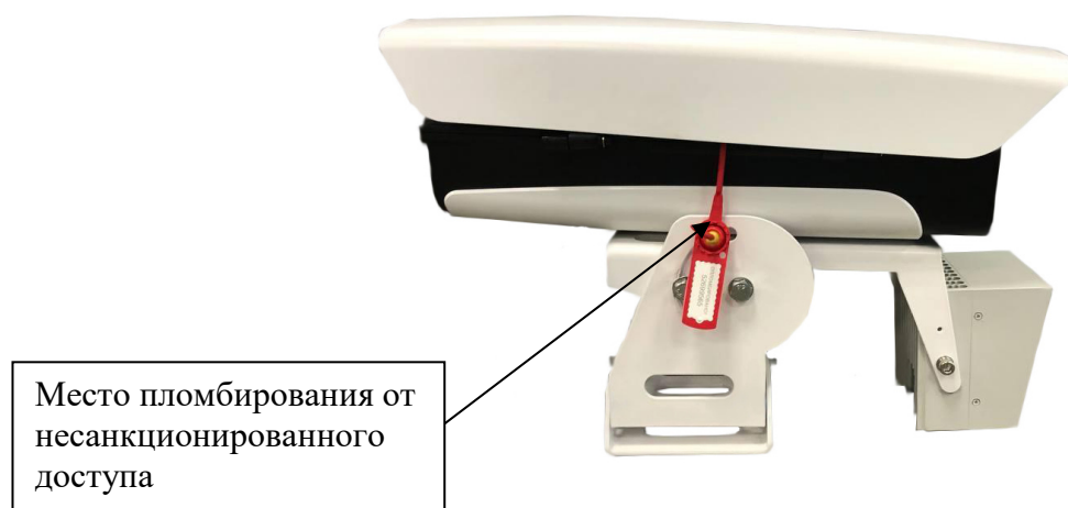
Рисунок 2.2 – Схема пломбировки от несанкционированного доступа «ПРИЗМА-М-2»
