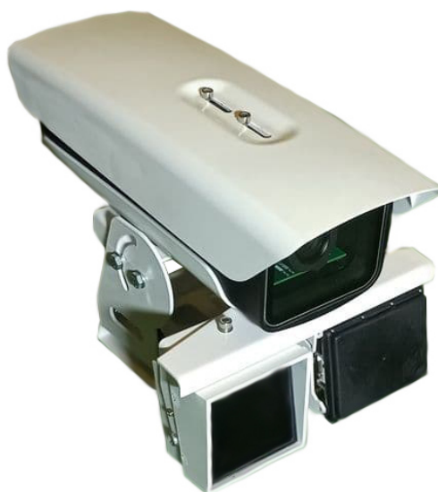
Рисунок 1.4. Общий вид ИМ «ПРИЗМА-М-2» с радиолокационным модулем
