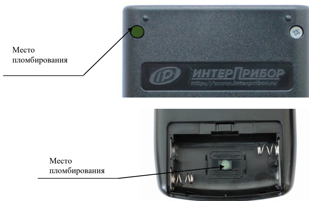
Рисунок 4 – Место пломбирования от несанкционированного доступа на панели электронного блока измерителя МИТ-1
