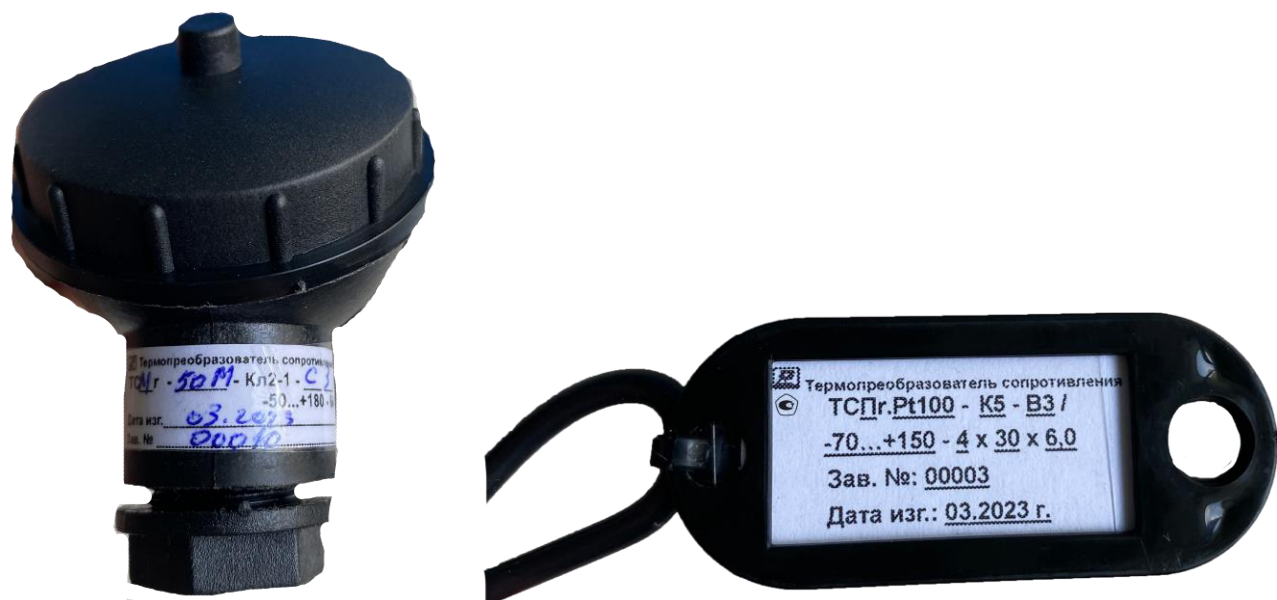
Рисунок 2 – Общий вид маркировки термопреобразователя модификации ТСПр
