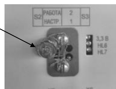
Рисунок 16 – Схемы пломбировки блоков управления серии «Топаз-306БУ»
