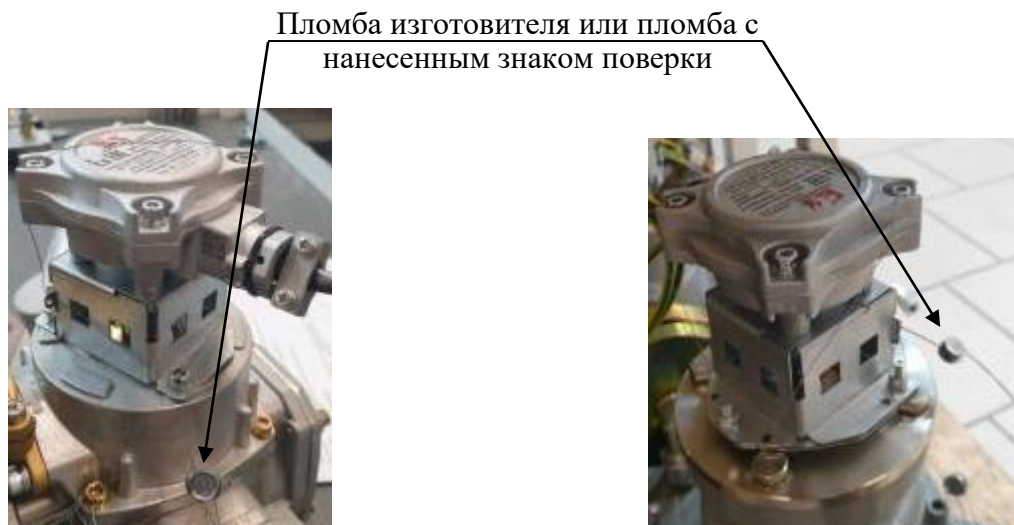
Рисунок 12 – Схемы пломбировки генераторов импульсов
