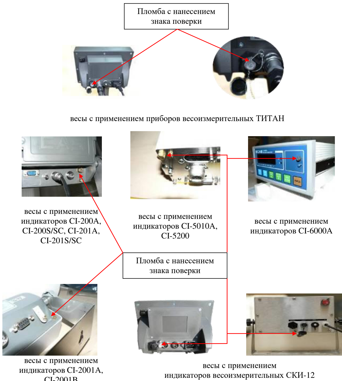
Рисунок 3 – Места ограничения доступа к местам настройки (регулировки)
