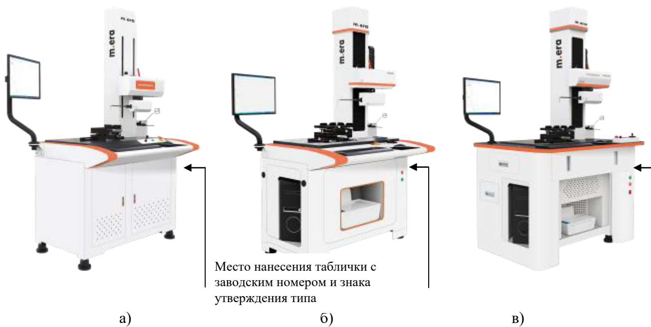
Рисунок 2 – Общий вид приборов m.era для измерений параметров контура поверхности модификации: а) Aurum C1; б) Aurum C2; в) Aurum C3
