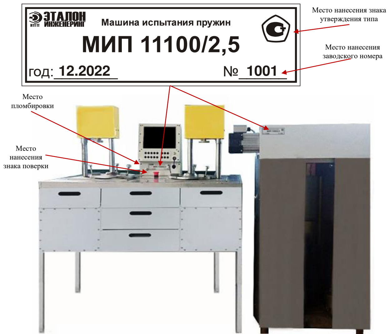
Рисунок 2 – Общий вид машины испытания пружин МИП, модификация МИП 11100/2.5, с указанием мест пломбировки, мест нанесения знака утверждения типа, знака поверки и заводского номера
