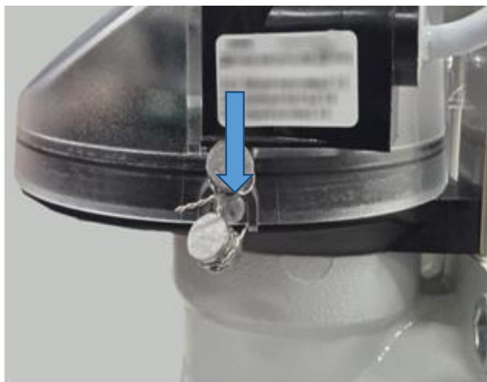
Рисунок 5 – Схема пломбировки от несанкционированного доступа места присоединения датчика импульсов, обозначение места нанесения знака поверки счетчика газа
