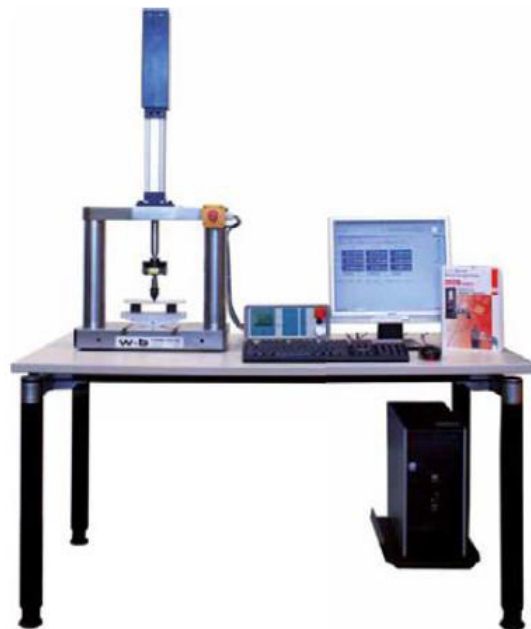
Рисунок 2 - Общий вид машин испытательных универсальных серии LFM, модификаций LFM-C-1, LFM-C-3, LFM-C-5, LFM-C-10, LFM-C-20, LFM-C-25, LFM-C-50
