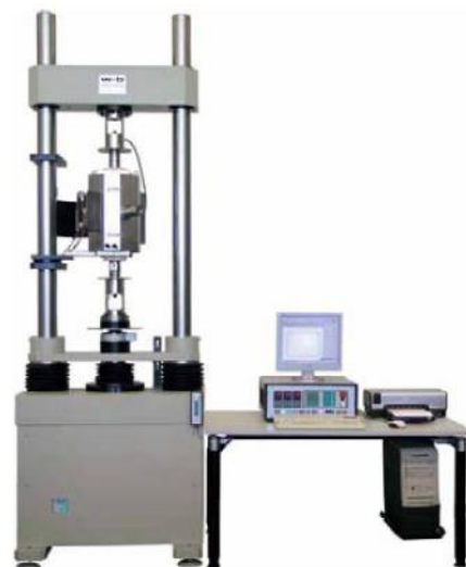
Рисунок 8 - Общий вид машин испытательных универсальных серии LFM, модификаций LFM-Z-200, LFM-Z-250, LFM-Z-300, LFM-Z-400, LFM-Z-500, LFM-Z-600
