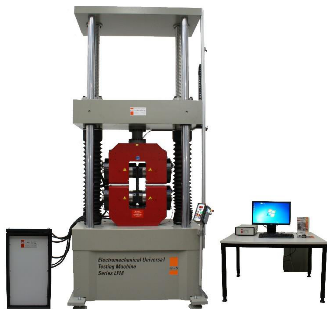
Рисунок 6 - Общий вид машин испытательных универсальных серии LFM, модификаций LFM-1000, LFM-1200, LFM-1500, LFM-2000
