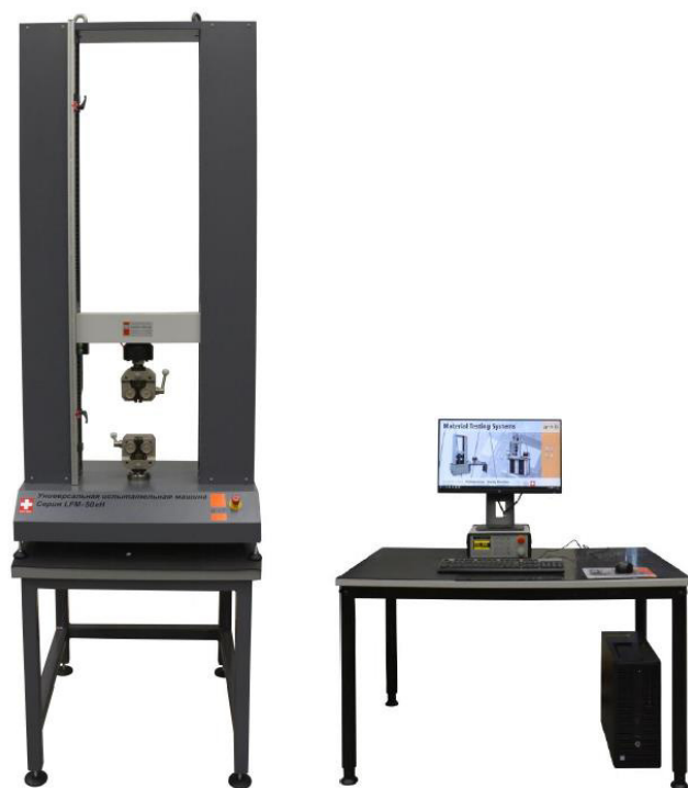
Рисунок 4 - Общий вид машин испытательных универсальных серии LFM, модификаций LFM-10, LFM-20, LFM-30, LFM-50, LFM-BS 50, LFM-75, LFM-100 (настольное исполнение)
