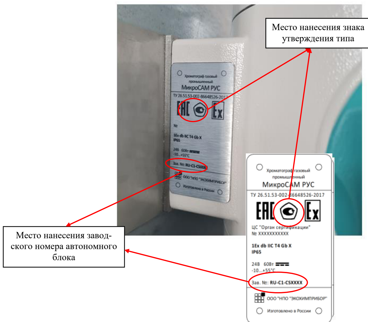
Рисунок 2 – Место нанесения заводского номера и знака утверждения типа
