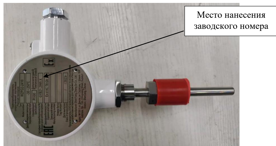
Рисунок 1 – Общий вид ТС с указанием места нанесения заводского номера
