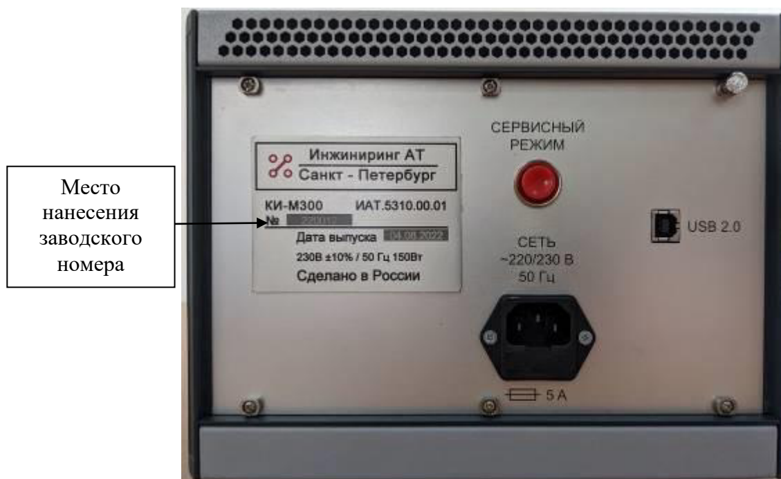
Рисунок 2 – Вид задней панели контроллеров и место нанесения заводского номера
