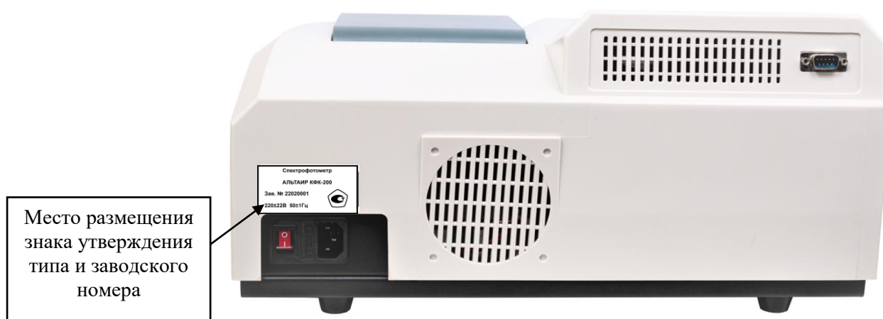
Рисунок 2 – Задняя стенка спектрофотометра Альтаир КФК-200
