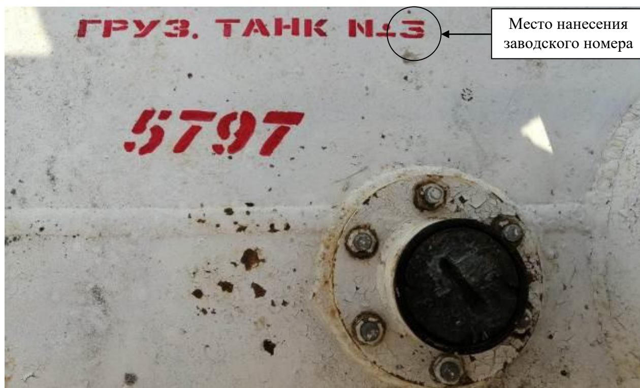
Р и с у н о к 3 – Общий вид замерного люка и места нанесения заводского номера
