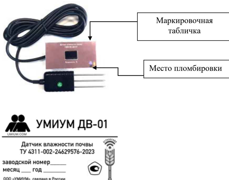
Рисунок 1 – Общий вид датчиков УМИУМ ДВ-01, маркировочной таблички с указанием заводского номера, знака утверждения типа, и схемы пломбировки от несанкционированного доступа
