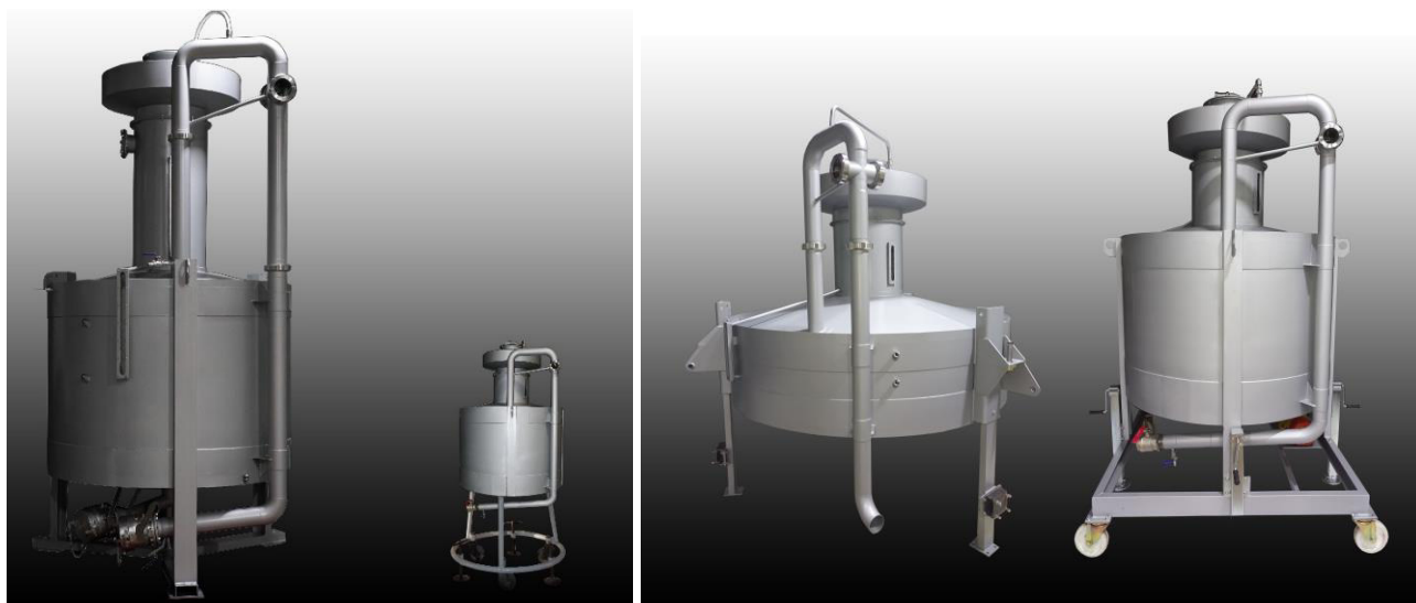
Рисунок 1 - Общий вид мерников металлических эталонных 2-го разряда с нижним донным наливом М2р
