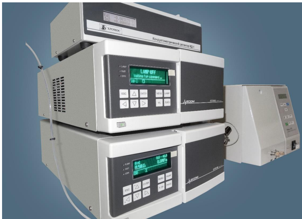
Рисунок 1 - Общий вид аналитической системы хроматографа жидкостного «Хромос ЖХ-301»
