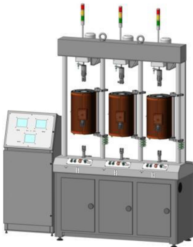
Рисунок 7 – Общий вид машин ТС ДП-3-Р-Х-У-ГР/1 (нижнее расположение рычажной системы)
