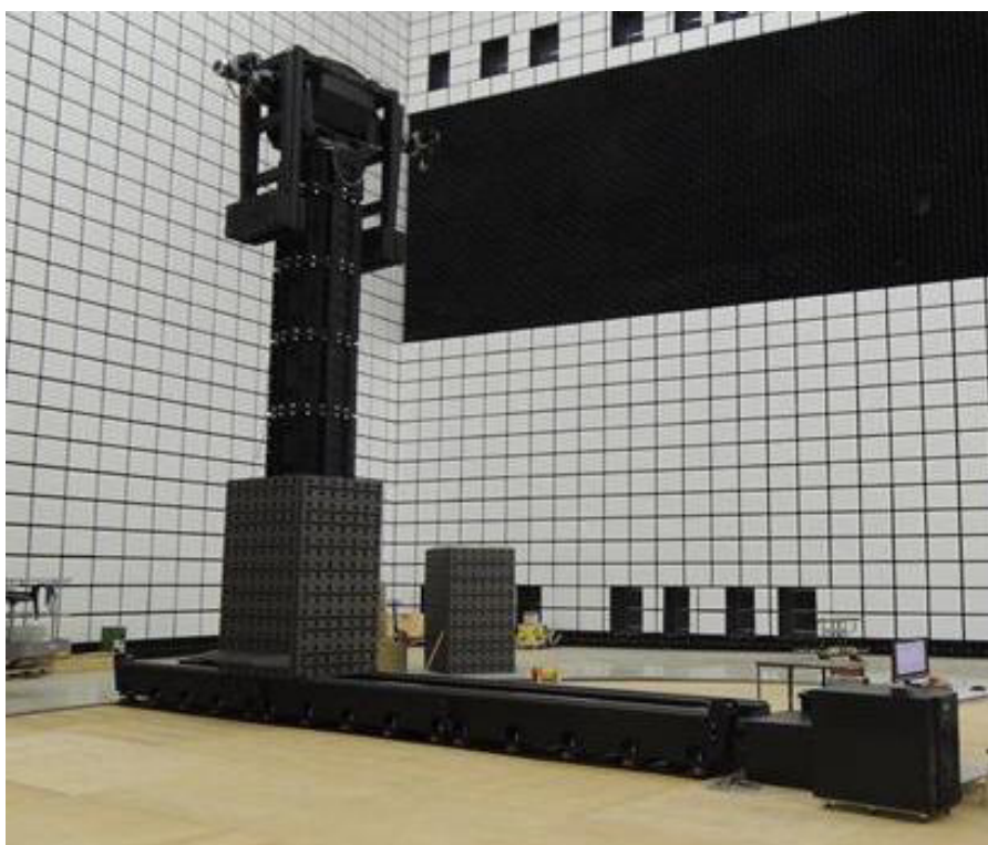
Рисунок 1 – Внешний вид прецизионного четырехкоординатного позиционера РЛТГ.411722.009 на прецизионном однокоординатном позиционере РЛТГ.411722.010
