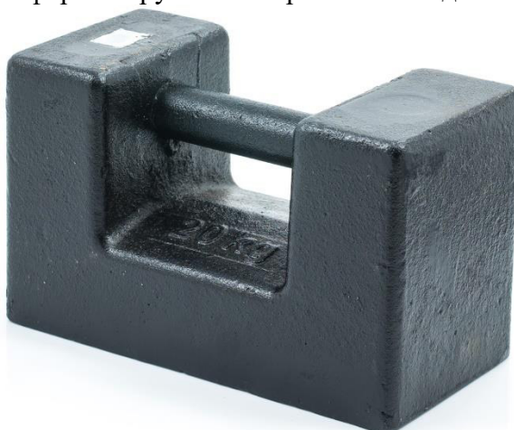
Рисунок 4 – Общий вид гирь из чугуна с номинальной массой от 5 кг до 20 кг параллелепипедной формы с ручкой
