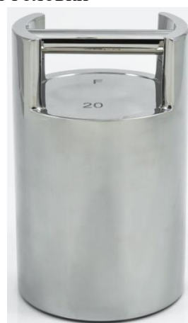
Рисунок 3 – Общий вид гирь из нержавеющей стали с номинальной массой от 5 кг до 20 кг цилиндрической формы с ручкой и параллелепипедной формы с ручкой
