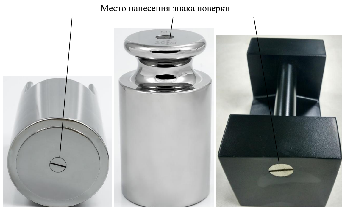
Рисунок 8 – Схема пломбировки от несанкционированного доступа и место нанесения знака поверки
