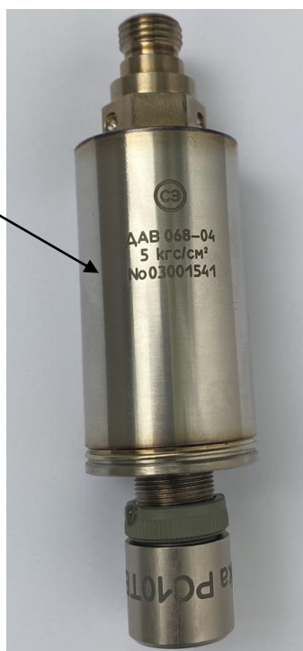
Рисунок 1 – Внешний вид датчика и место нанесения порядкового номера исполнения датчика, диапазона измерений и заводского номера
