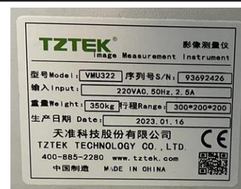
Рисунок 2 - Место расположения маркировочной таблички с указанием заводского номера прибора.
