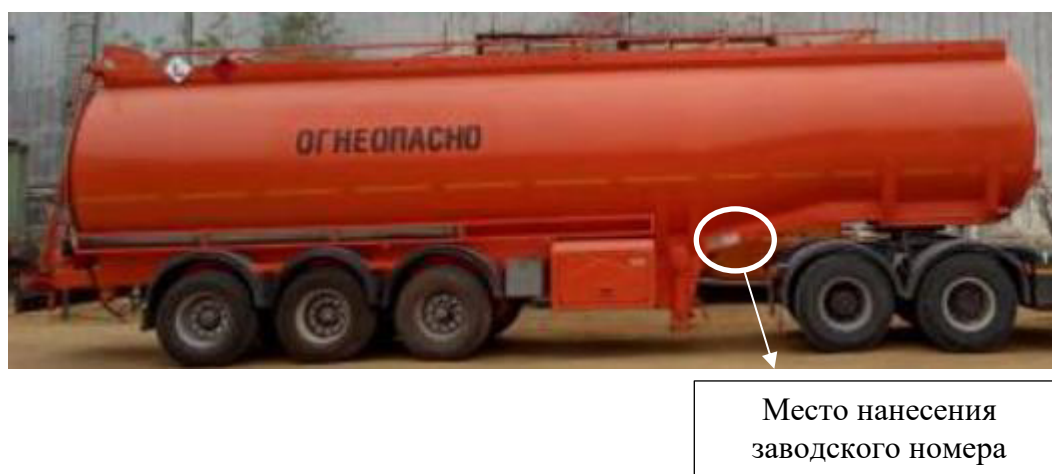
Рисунок 1 – Общий вид полуприцепа-цистерны OZGUL T22 и место нанесения заводского номера
