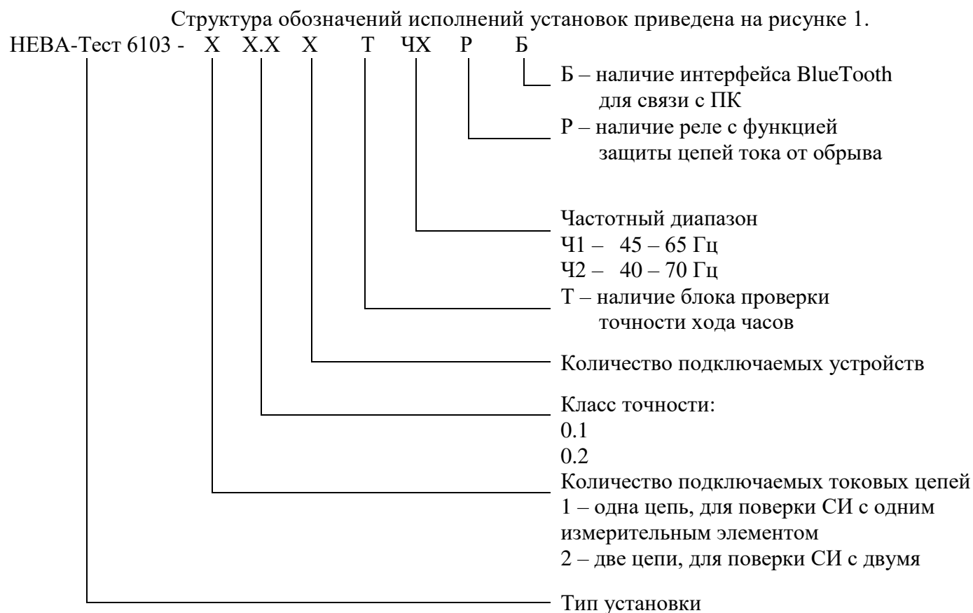
Рисунок 1 – Структура обозначений исполнений установок
