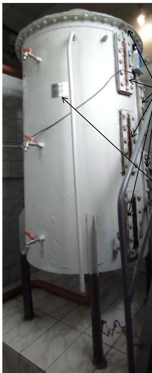
Рисунок 1 – Общий вид мерника стационарного металлического технического 1-го класса МСМТ-1 № 15/1 с указанием мест пломбировки и места нанесения заводского номера
