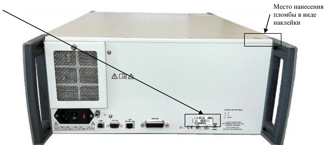
Рисунок 2 – Схема пломбировки от несанкционированного доступа, место нанесения маркировочной наклейки
