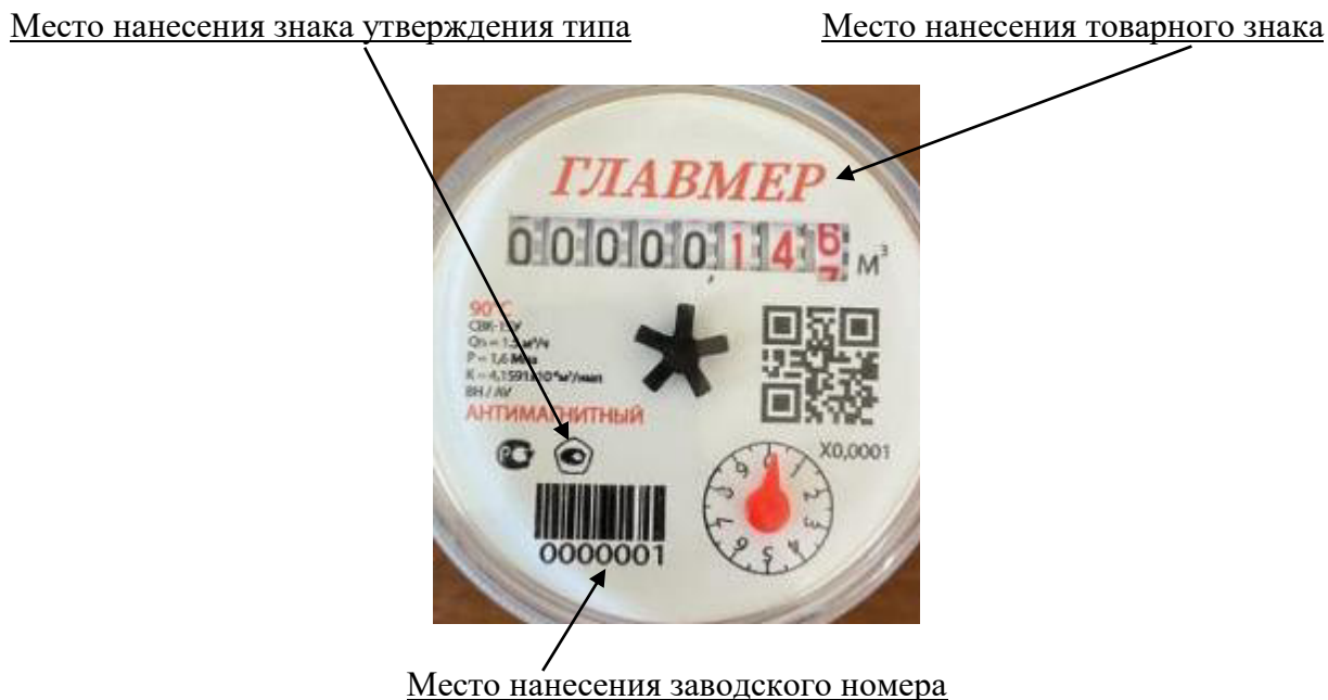
Рисунок 3 – Место нанесения знака утверждения типа, заводского номера, товарного знака.
