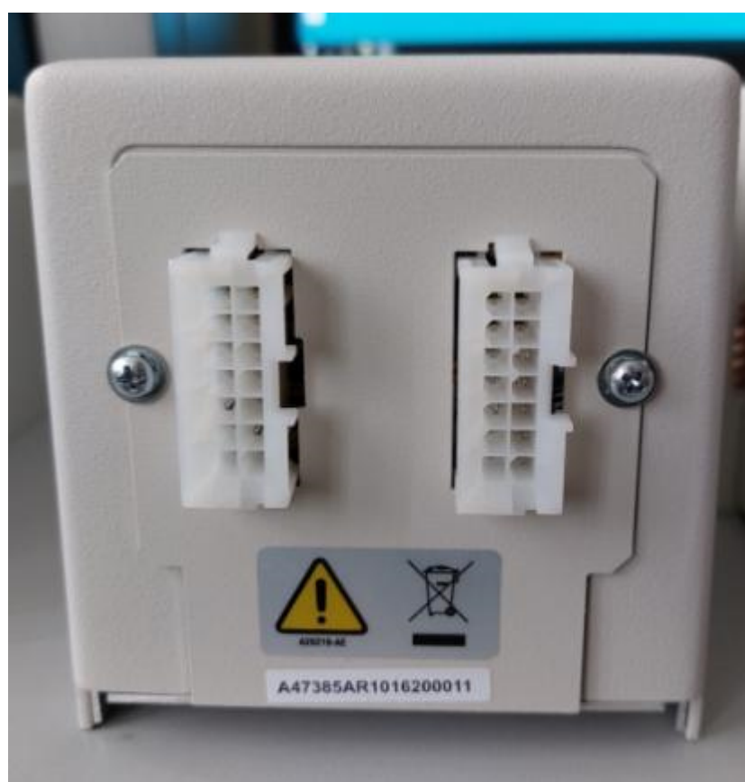
Рисунок 2 – Место нанесения заводского номера детектора
