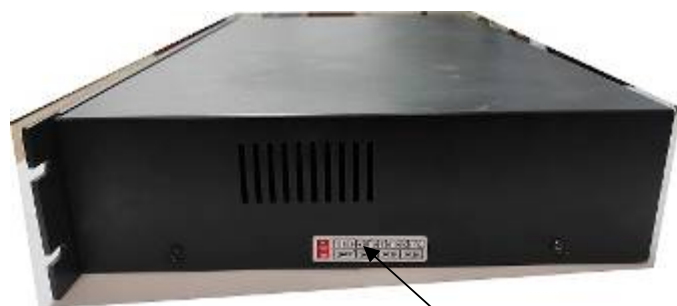
Рисунок 5 – Пломбирование корпуса контроллера
