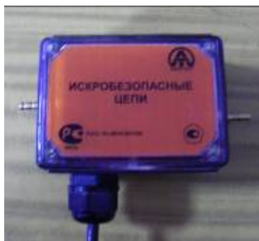
Рисунок 2. Дополнительный корпус с чувствительными элементами (первичным преобразователем) для модификации СД-1.ИД.Г
