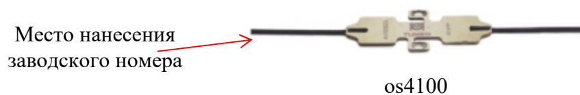
Рисунок 5 – Внешний вид брэгговских датчиков для компенсации дрейфа температуры
