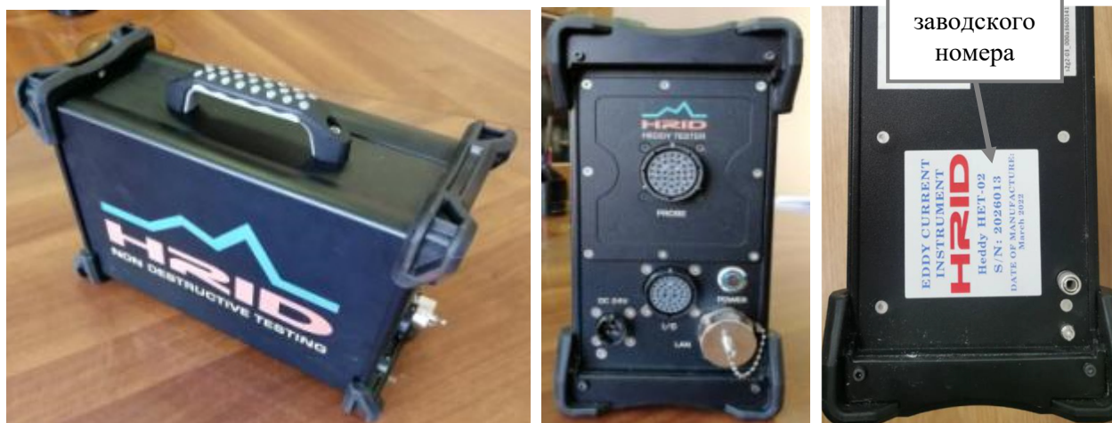
Рисунок 1 – Общий вид, обозначение места нанесения заводского номера дефектоскопов вихретоковых HRID Heddy HET-02
