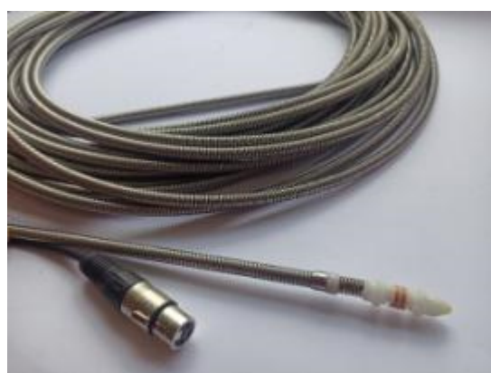
Рисунок 1 – Общий вид, обозначение места нанесения заводского номера дефектоскопов вихретоковых HRID Heddy HET-02
