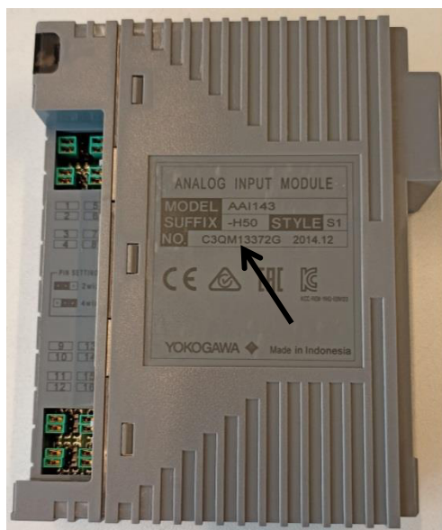
Рисунок 2 – Места нанесения заводских номеров на измерительные модули (слева) и на комплекс (справа)
