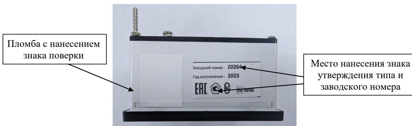
Рисунок 2 – Общий вид амперметров, вольтметров Э47 с указанием места нанесения знака утверждения типа и места нанесения заводского номера (вид сверху)
