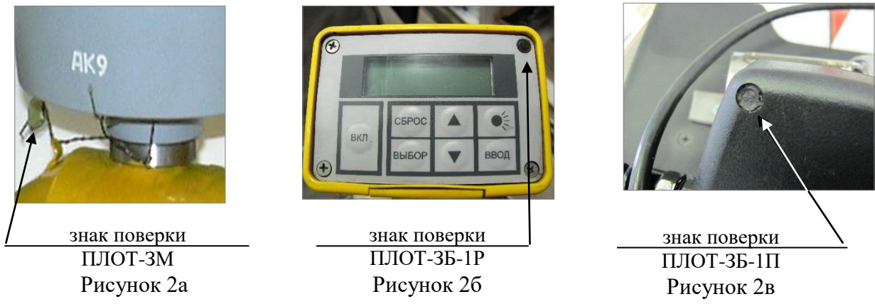
Рисунки 2а, 2б, 2в – Места пломбирования и нанесения знака поверки Рис
