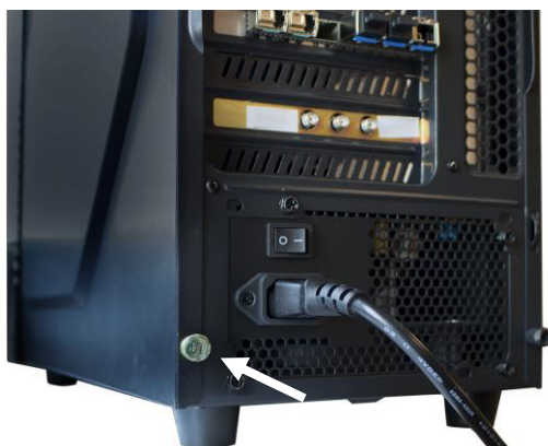
Место пломбировки блока обработки информации
