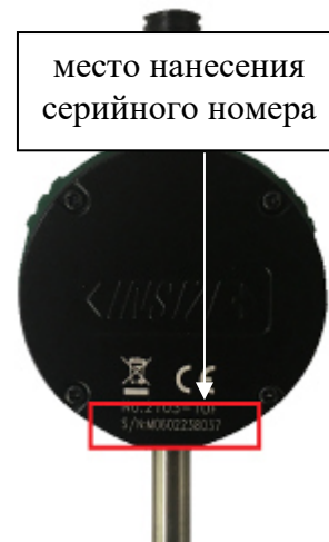
Рисунок 9 – Общий вид цифрового индикатора 2104-10F
