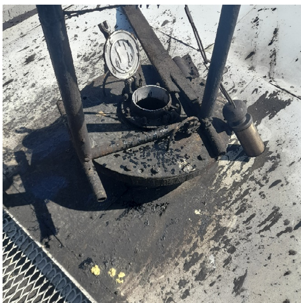
Рисунок 2 – Общий вид замерного люка и маркировочной таблички
