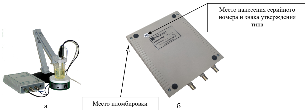
Рисунок 1-Внешний вид ИП анализатора ЭКОТЕСТ-ВА с электрохимической ячейкой (а), место пломбировки ИП анализатора от несанкционированного доступа, место нанесения серийного номера и знака утверждения типа (б)
