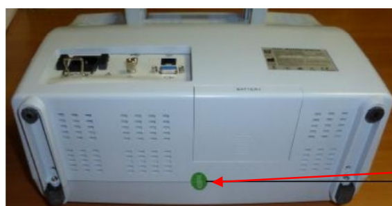
Рисунок 1 – Общий вид мониторов медицинских фетальных матери и плода модели G6A, G6B схема опломбирования от несанкционированного доступа (А)
