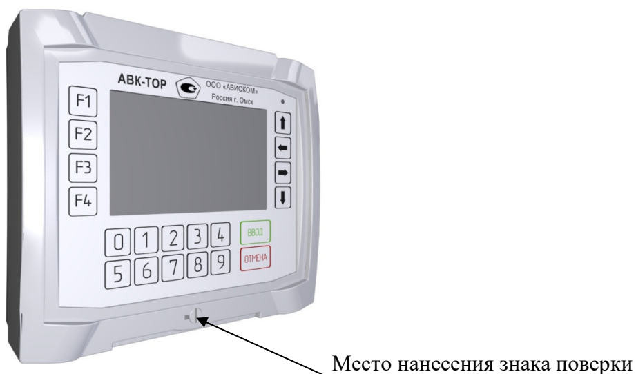
Рисунок 2 – Место нанесения знака поверки
