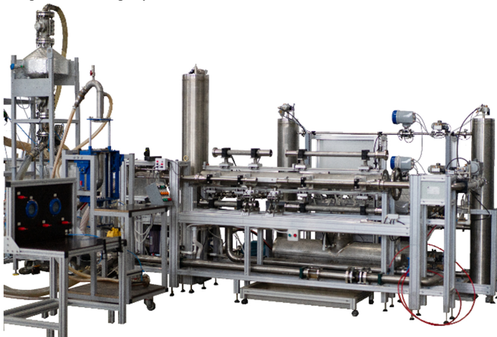
Рисунок 1 - Внешний вид установки поверочной расходомерной ULTRA-S-AL
