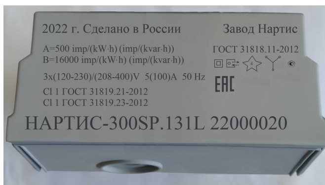
Рисунок 2 – Общий вид блока измерительного счетчика архитектуры «Сплит», мест пломбировки, мест нанесения знака утверждения типа, знака поверки, заводского номера.
