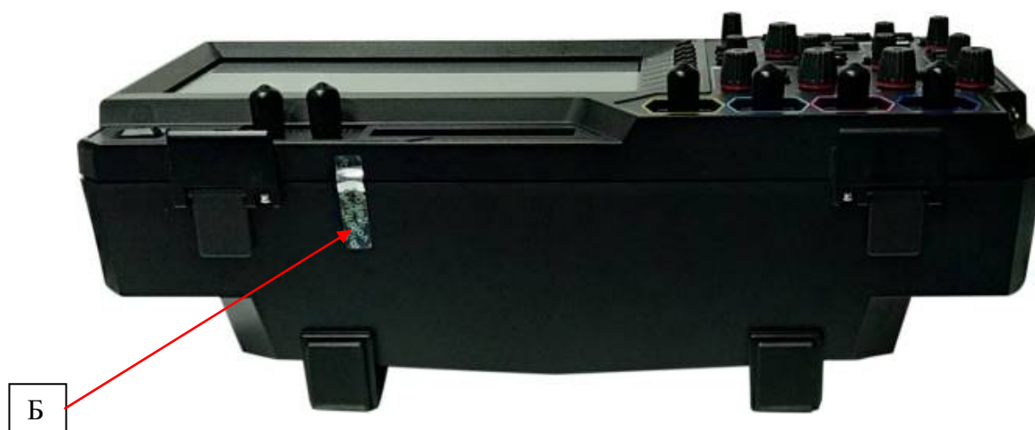
Рисунок 6 – Схема пломбировки от несанкционированного доступа (Б)
