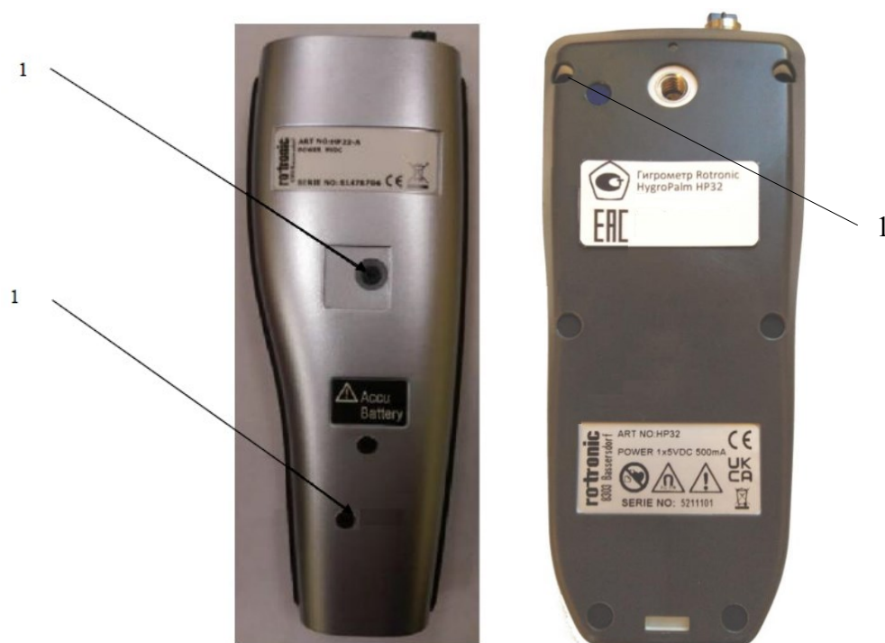
Рисунок 2 – Место пломбирования гигрометра Rotronic модификации HygroPalm в исполнении HP22-A (слева) и гигрометра Rotronic модификации HygroPalm в исполнении HP32 (справа)
