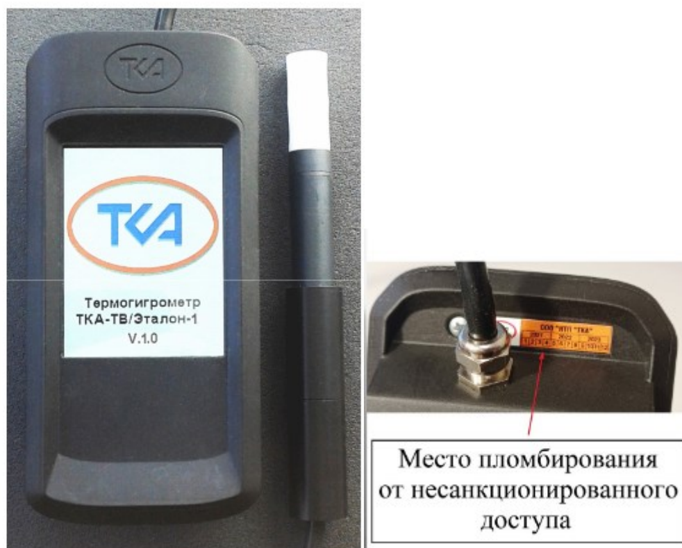
Рисунок 3 – Общий вид термогигрометра эталонного ТКА-ТВ/Эталон, модификация ТКА-ТВ/Эталон-1 и место пломбирования
