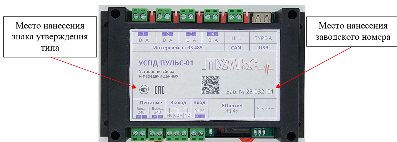
Рисунок 1 – Общий вид УСПД с указанием места нанесения знака утверждения типа и заводского номера
