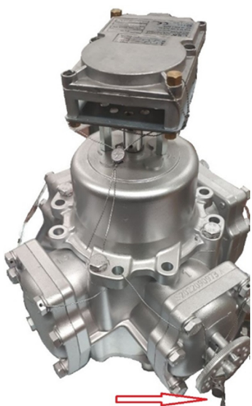
Рисунок 3 - Пломбировка измерителя объема JSJ4 по периметру верхней и боковых крышек
