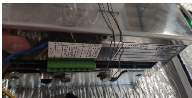
Рисунок 5 - Пломбировка БУ YS06-L
