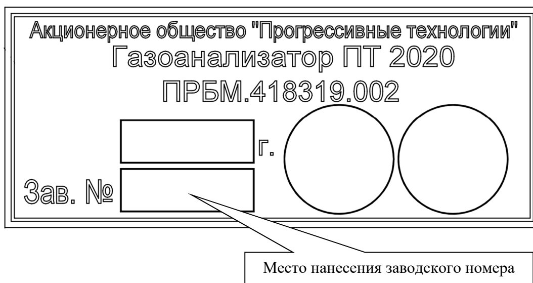
Рисунок 2 - Общий вид таблички с маркировкой газоанализатора
