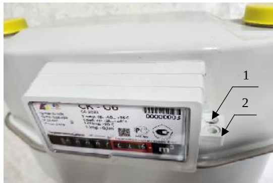
Рисунок 2 – Схема пломбировки счётчика и место расположения знака поверки счетчика
