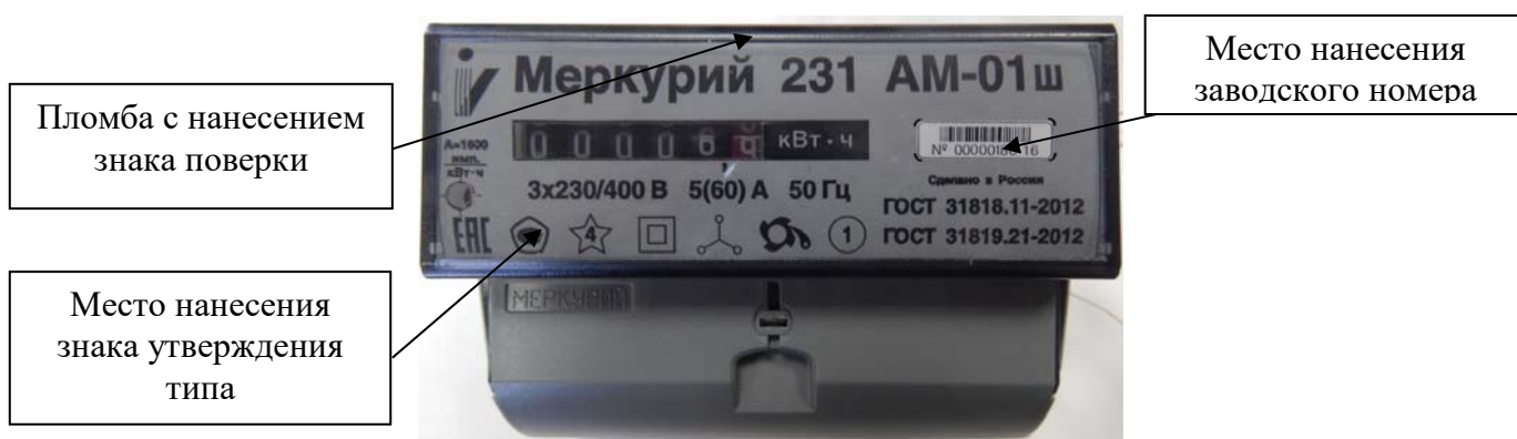
Рисунок 2 – Общий вид счетчиков «Меркурий 231АМ-0Хш» с указанием места ограничения доступа к местам настройки (регулировки), места нанесения знака утверждения типа, места нанесения заводского номера
