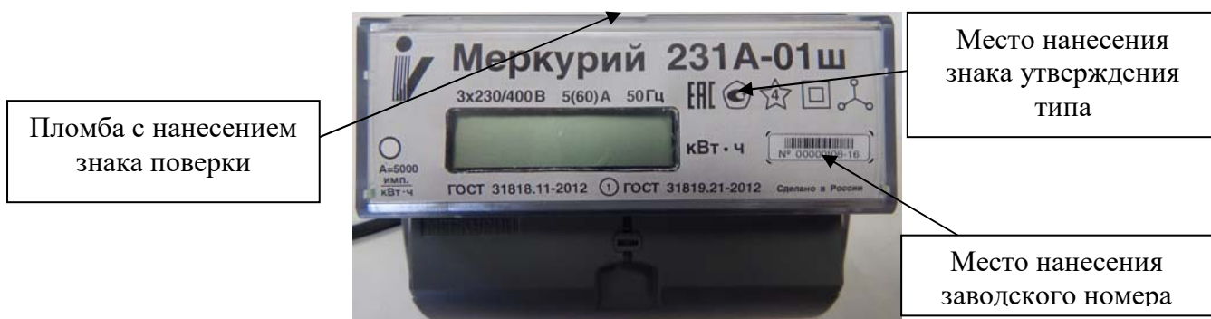
Рисунок 3 – Общий вид счетчиков «Меркурий 231А-0Хш» с указанием места ограничения доступа к местам настройки (регулировки), места нанесения знака утверждения типа, места нанесения заводского номера
