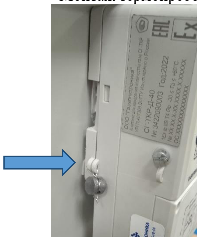
Монтаж термопреобразователя сопротивления Pt500 (500П) на корпусе счетчика
