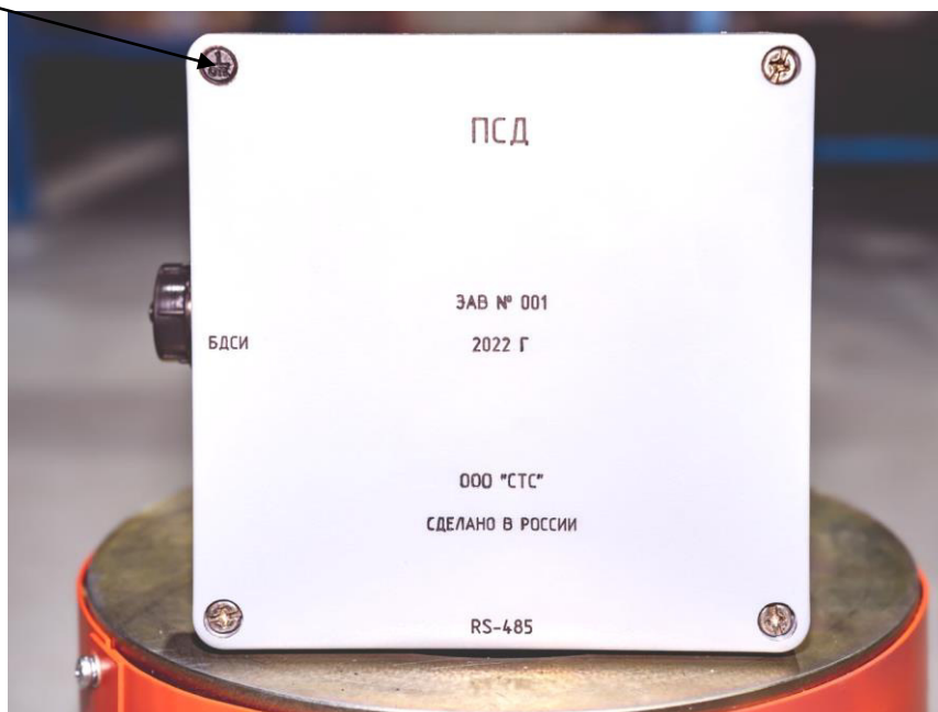
Рисунок 3 – Место пломбировки ПСД от несанкционированного доступа
