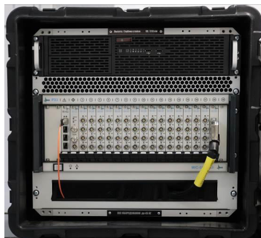
Рисунок 2 – Станция сбора данных БЛИЖ.408310.002.132. Комплекс измерительный MIC-553PXI и PromPC
