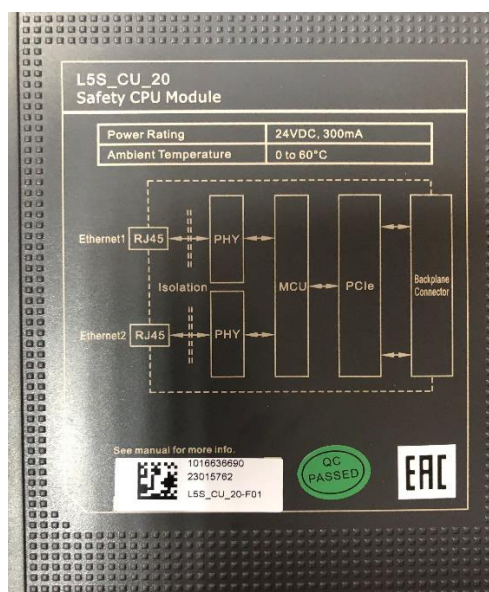
Рисунок 4 – Место нанесения заводского номера контроллера
