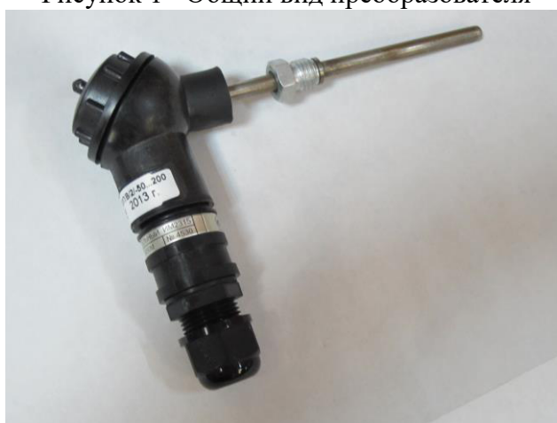
Рисунок 2 - Преобразователь в сборе с термопреобразователем сопротивления
