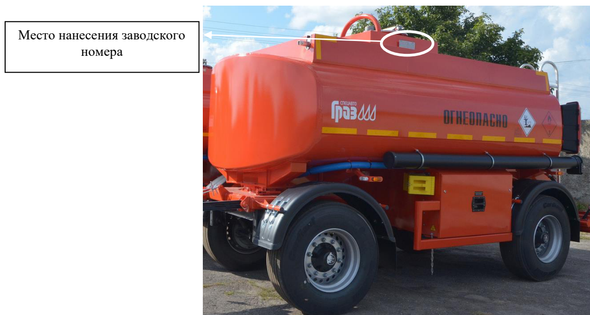
Рисунок 1 – Общий вид прицепа-цистерны GRAZ-ГРАЗ-ПЦ-10,7 и место нанесения заводского номера
