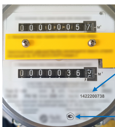
Рисунок 2 – Места нанесения заводского номера, знака утверждения типа для счетчиков в исполнении «Р»
