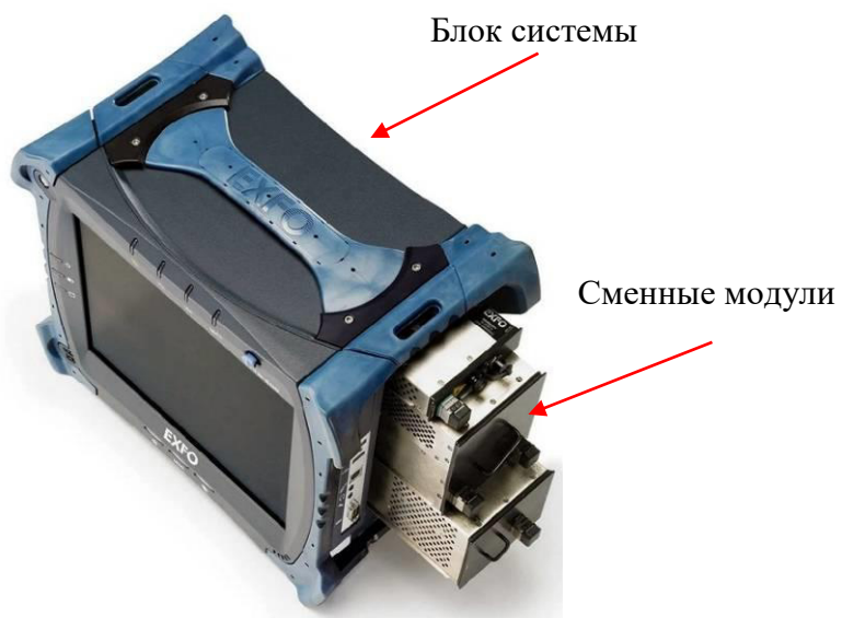
Рисунок 1 – Установка сменных модулей в блок системы
