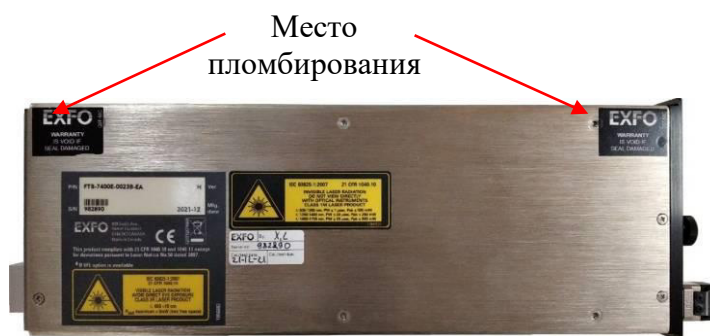
Рисунок 2 – пример схемы пломбирования сменного модуля
