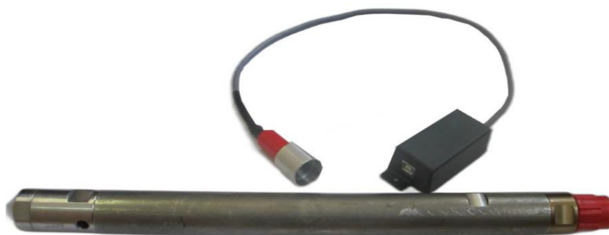
Рисунок 6 – Общий вид манометров-термометров модификации АЦМ-6.2-30 с адаптером
