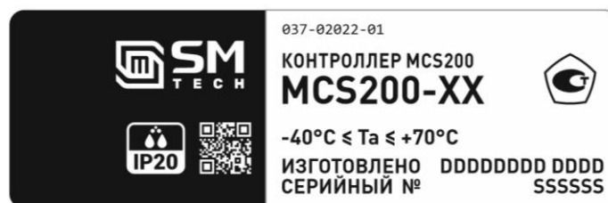
Рисунок 2 – Способ нанесения заводского номера контроллера
