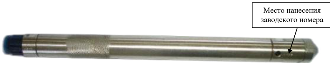
Рисунок 1 – Общий вид манометров-термометров модификации АЦМ-6-30, АЦМ-8-30
