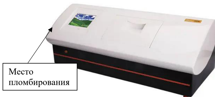
Рисунок 1 – Общий вид поляриметров автоматических цифровых Hanon P
