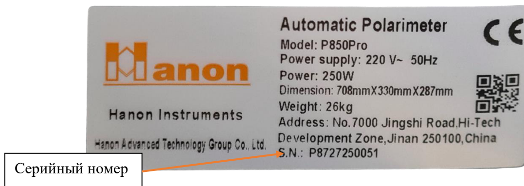
Рисунок 2 – Идентификационная табличка поляриметров
