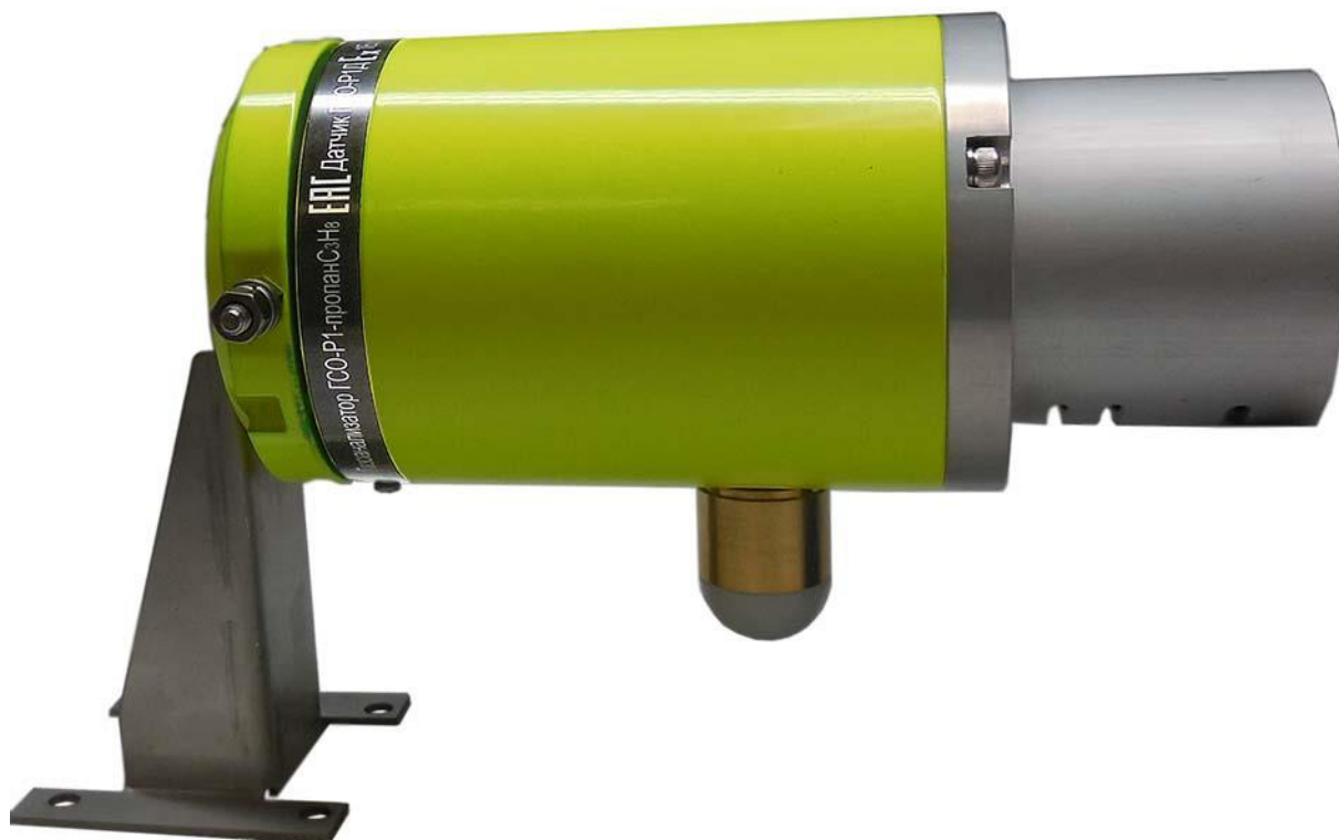
Рисунок 4 - Внешний вид газоанализаторов стационарных оптических ГСО-Р1, датчик ГСО-Р1Д с трехцветным светодиодом
