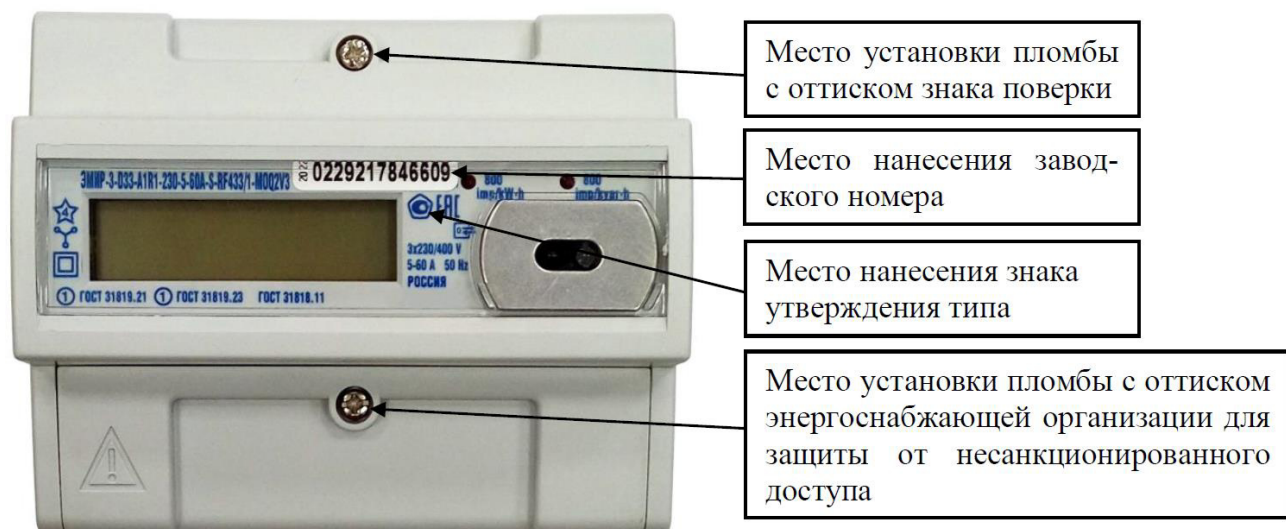
Рисунок 5 – Общий вид счетчика в корпусе типа D33
