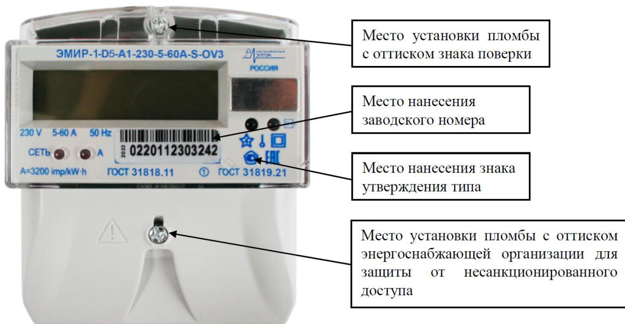
Рисунок 9 – Общий вид счетчика в корпусе типа D5
