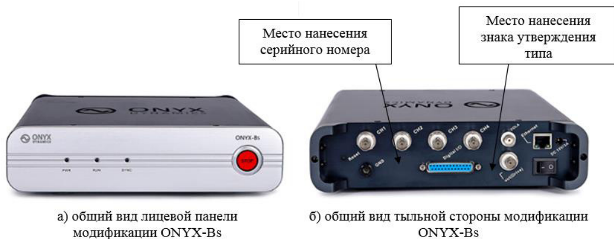
Рисунок 4 – Общий вид аппаратуры моноблочного исполнения в металлическом корпусе прямоугольной формы (модификация ONYX-Bs) с указанием места нанесения знака утверждения типа и места нанесения серийного номера
