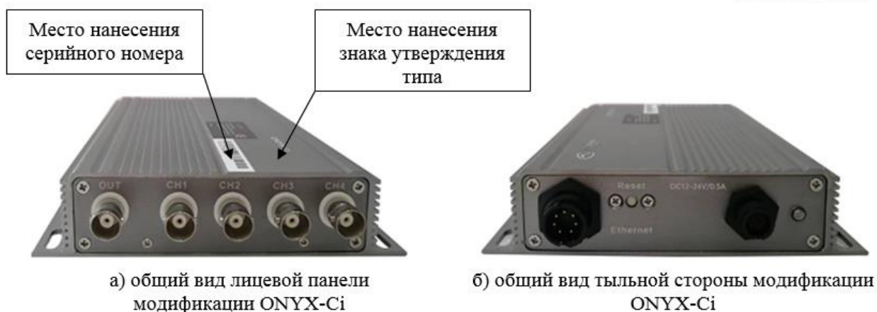
Рисунок 3 – Общий вид аппаратуры моноблочного исполнения в металлическом корпусе прямоугольной формы (модификация ONYX-Ci) с указанием места нанесения знака утверждения типа и места нанесения серийного номера
