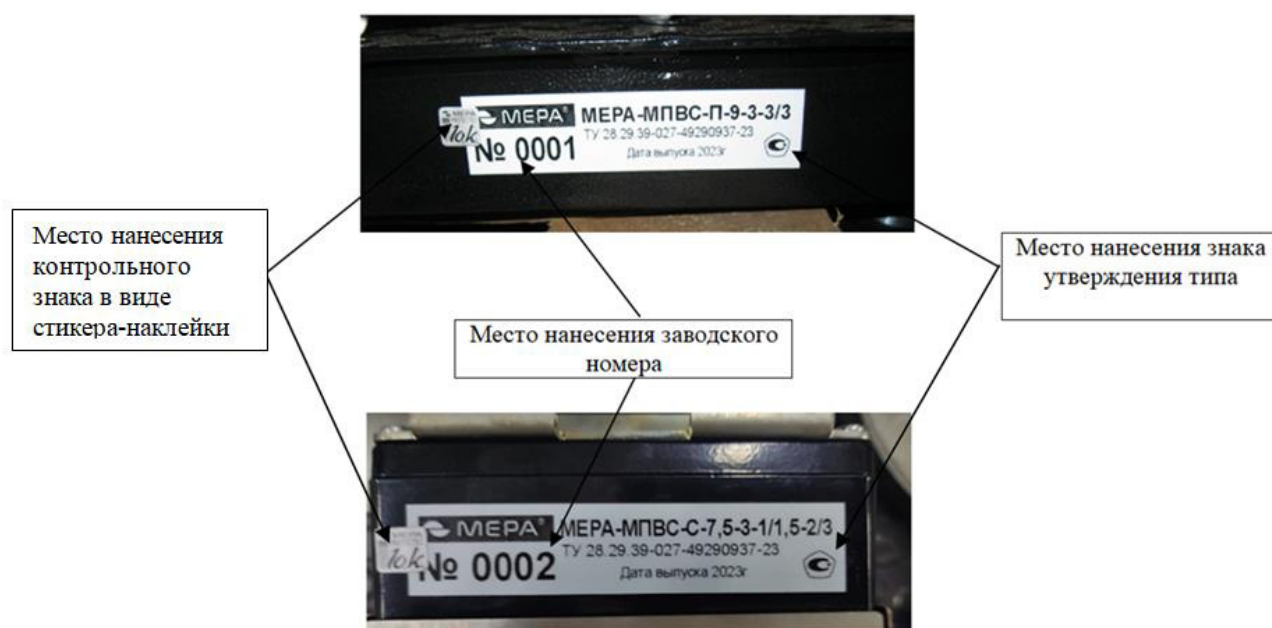
Рисунок 3 - Примеры маркировочных табличек средства измерений с указанием мест нанесения контрольного знака изготовителя в виде стикера-наклейки, мест нанесения знака утверждения типа и заводского номера
