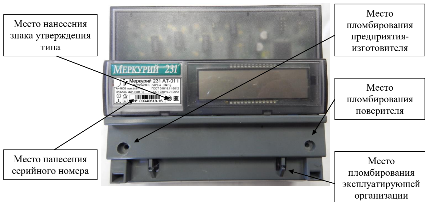
Рисунок 3 – Общий вид счетчиков «Меркурий 231 АТ-0Х», «Mercury 231 АТ-0Х» с указанием мест пломбирования и нанесения знака поверки, знака утверждения типа, серийного номера
