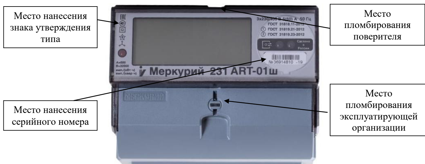
Рисунок 4 – Общий вид счетчиков «Меркурий 231 АРТ-0Хш», «Mercury 231 АРТ-0Хш» с указанием мест пломбирования и нанесения знака поверки, знака утверждения типа, серийного номера
