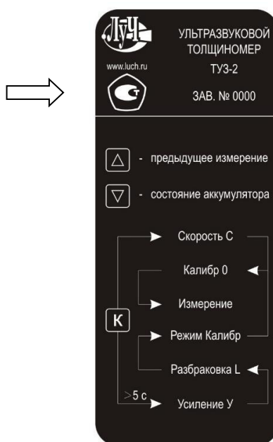
Рисунок 2б – Общий вид задней панели толщиномеров ультразвуковых ТУЗ-2 в металлическом и пластиковом корпусе (исполнение 1б и 1в) и место нанесения знака утверждения типа
