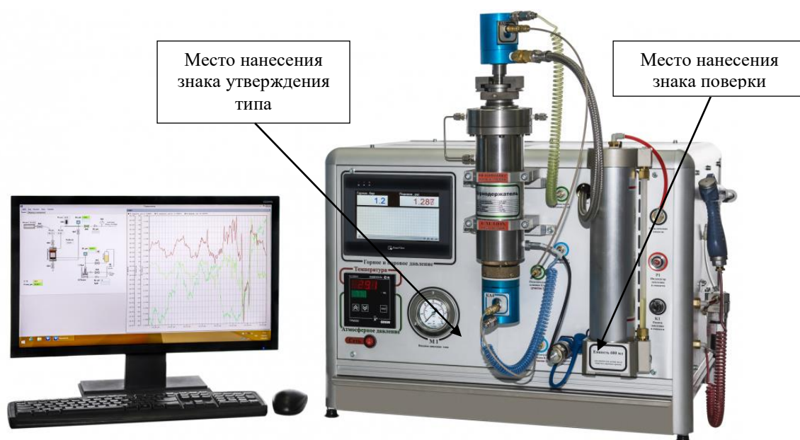
Рисунок 1 – Общий вид анализаторов газопроницаемости и пористости ПИК-ПП, оснащенных манометром входного давления, место нанесения знака поверки и знака утверждения типа
