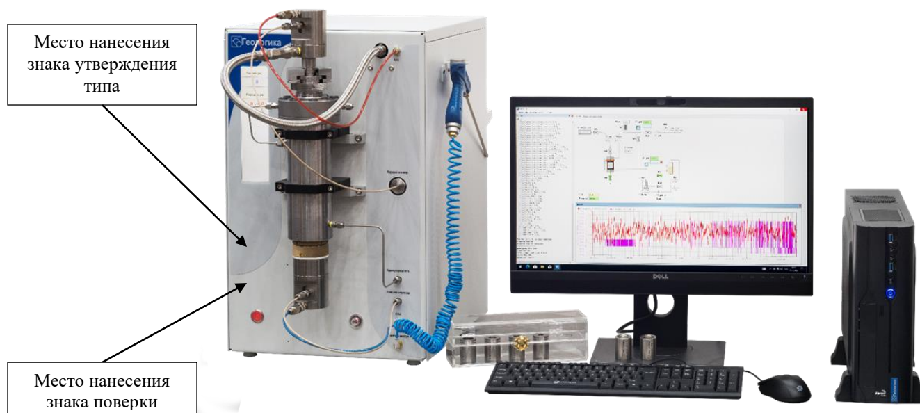
Рисунок 3 – Общий вид анализаторов газопроницаемости и пористости ПИК-ПП, не оснащенных манометром входного давления, обозначение места нанесения знака поверки и знака утверждения типа
